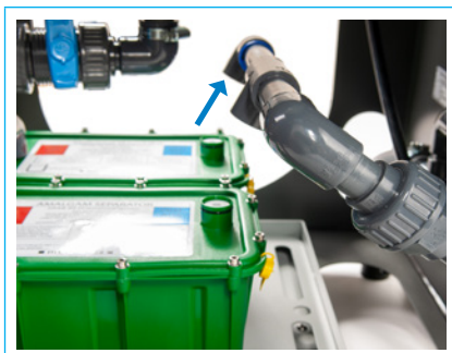
Bild. 118 Fälla upp utloppsbyggnaden
