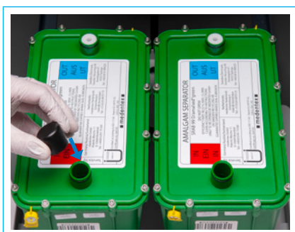
Bild. 122 Stäng och förvara förbrukade amalgamavskiljare
