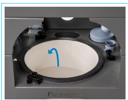
Bild. 82 Ta ut tanksilen
